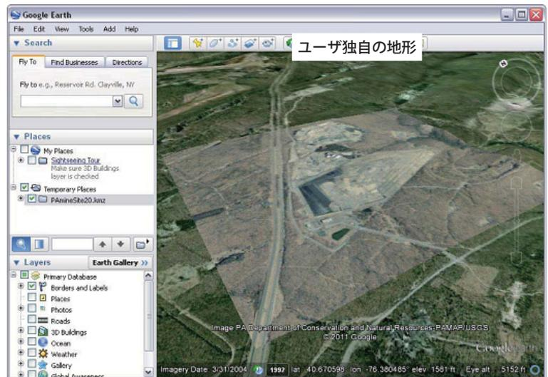
ペンシルベニア州の露天掘りの鉱山サイトの例。左図はそのままの Google Earth、右図は鉱区をカバーするカスタムの Google Earth 3D タイルセット (ユーザ独自の DEM データを使用) です。右図のこのタイトルセットは、セルサイズ 1 メートルの Lidar の DEM とセルサイズ 0.3 メートルのナチュラルカラー (落葉時) 正射画像 (共に 2008 年に取得) を使用して、TNTmips の Google Earth 3D タイルセットのエキスポート処理で作成されました。2008 年の画像と DEM は、Google Earth の地形や画像と比べて、鉱山での開発がより進行している事を示しています。
