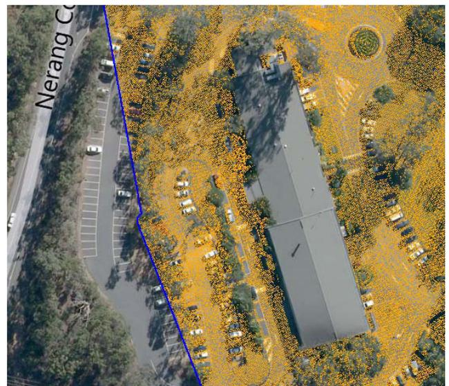
左上：クラスでスタイル付けした分類済み Lidar ポイントファイルの TNTmips 表示。この領域には大きな建物 (赤のポイント)、植生 (緑)、駐車場と道路が含まれています。左下部分にポイントの色の凡例が置かれています。背景の参照レイヤは Bing Maps のラベル付き航空写真です。青い線はリージョンオブジェクトの境界で、Lidar マネージャで線の右側の地面のポイントを抜き出すよう指定されています。右上：抜き出した地面のポイント (茶色) の出力 LAS ファイルの TNTmips 表示。リージョンの内側の地面ポイントだけが抽出されています。
