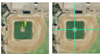
インポート後の推定された画像位置における GPS コントロールポイント (左)。[編集] モードを使って正しい画像位置に再配置 (右)。
