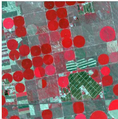
上図は、ある農地の QuickBird マルチスペクトル画像の近赤外線、赤、緑バンド(この順番)の RGB 表示です。右の相関図は赤バンドを X 軸に、近赤外線バンドを Y 軸にプロットしています。典型的な「房付き帽子」の形の離散図です。
