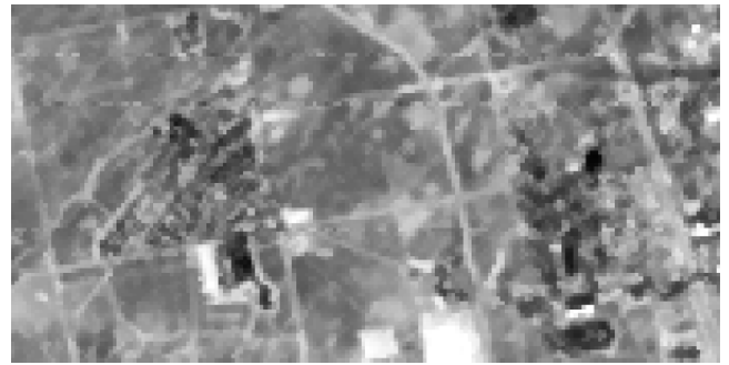
は P-Median フィルタの平滑化の効果によって大きく減少しています。他方、道路や農地の境界沿いの縁や線状の細部は保たれています。
