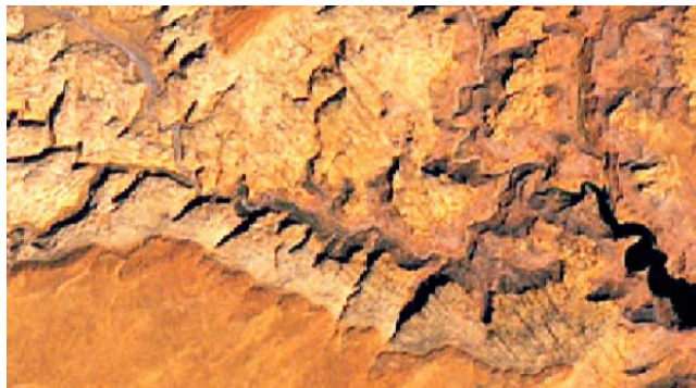
(左) 岩石層の露頭がある砂漠地帯のカラー衛星画像(セルサイズ 15 m)。垂直な破碎面に北西-南東方向の傾向が見られる。(右) 同じ画像を、北西-
