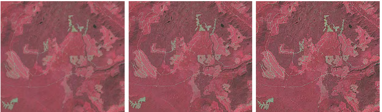
画像のフィルタの適用例。ランドサット画像の3バンドのRGBに適用。バンドを組み合わせて、植生が赤く見えるようにカラー赤外表示をしている。図は伐採の歴史が明白に示されている森林地帯を表しています。成熟した森林地帯は濃い赤色、再成長した伐採土地は明るい赤色、そして最も明るい赤色と灰色の斑点は最近伐採された区域です。一番左の図は加工されていない、フィルタなしの表示です。他の2枚の図は3x3のハイパス・シャープニングフィルタを使った結果です：中央の図は40%のフィルタされた画像と60%のオリジナル画像の組み合わせ ([量] スライダーを40に設定) で、一番右の図は80%のフィルタされた画像と20%のオリジナル画像の組み合わせ ([量] スライダーを80に設定)。
