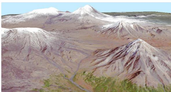
カムチャッカ（ロシア東部）の火山群の 3 次元鳥瞰図表示；SRTM90 標高データから一部抜粋した地形の上にランドサット 7 シーン（セルサイズ 30 メートル）を重ねて表示。
