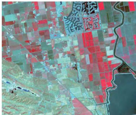
ASTER 画像バンドの赤外カラー表示 (Red= 近赤外バンド、Green= 赤バンド、Blue= 緑バンド)。SRFI および TERCOR の両スクリプトを使用して反射率に較正されました。別の日付の2枚のバンド表示は同じコントラスト強調を使用しています。従って、2枚の画像で類似している色は同じ反射率を表わしています。反射率の計算にあたり、バンドによる影響（大気散乱）やシーン間の影響（太陽光照射方向の違いや緑と赤バンドでのセンサーゲインの違い）、とりわけ勾配と傾斜方位による反射率への影響が補正されています。これらの較正済み画像はある日の作物や自然の植生、土壌、岩石の鉱物組成やその他の性質を解析したり、シーン間で比較する上で、より改善された基盤を提供してくれます。例えば、下の図は上図の四角で表わされた範囲の最適化された植生指数を表わしています。この画像は、本シリーズの中の GRUVI スクリプトを使用して計算しました。
