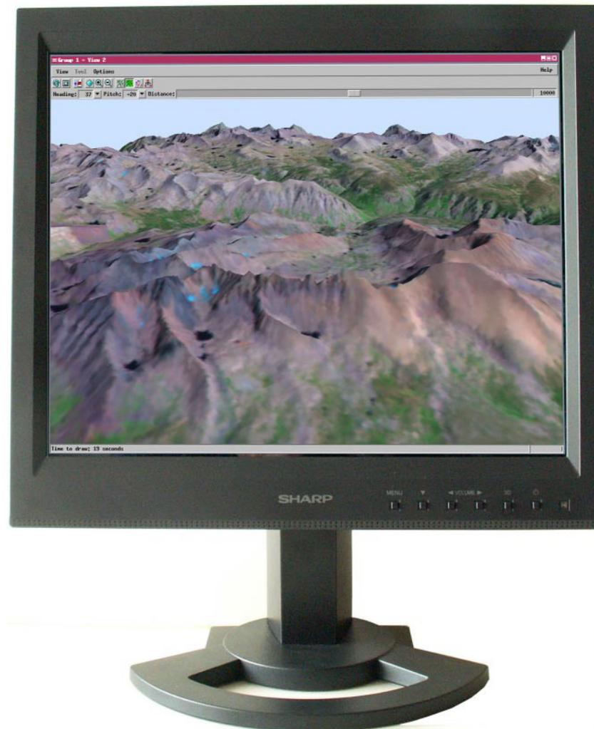
高解像度のオルソ (正射) 画像およびデジタル標高モデルは現在広く入手可能です。TNTmips や TNTedit、TNTview で高品質なステレオ表示が可能であり、2次元や3次元鳥瞰図表示のパワーを増強します。ステレオ表示は、直接フィールド調査を行うには費用や時間がかかったり危険を伴う場合に、地上の状態や特徴を調べ図化するのに効果的です。ステレオ表示はまた、地表面とその下の構造の3次元空間を明らかにするのに効果的です。ステレオ表示は TNTmips および TNTedit の空間エディタで利用でき、2D ウィンドウでの地理データの編集作業をアシストします。
