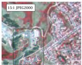
DWT 方式による JPEG2000 はノイズを発生せず、はるかに良い画像精細度を保持しています。(四角内は圧縮前の原画像です。)
