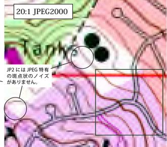
JPEG2000 は本当に JPEG よりも優れているでしょうか?スキャンした地図で確かめてみました。この地図は 300dpi で 24bit TIFF 画像にスキャン後、JPEG と JPEG2000 に変換しました。それぞれの手法で 20:1 圧縮を行った結果が上の図です。注意深く観察すると違いが分かりますが、細かい点を除いて、スキャン地図の 20:1 圧縮レベルでは JPEG2000 と JPEG は大差ありません。(JPEG2000 の図内の四角は圧縮前の 24 ビット原画像です。)
