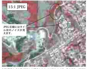
DCT 圧縮方式の旧 JPEG には明らかなタイル状のノイズ、色の劣化、線状地物のぼやけが見られます。
