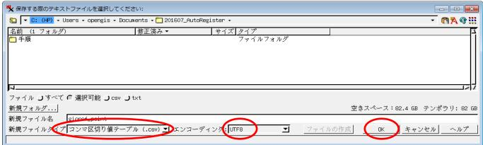
(2) ジオリファレンス入力ファイルを開く > インポート ジオリファレンス処理のメインウィンドウで、コントロールポイントの転写先となるデータを開きます。 コントロールポイント > 入力(インポート)メニューを開きます。
