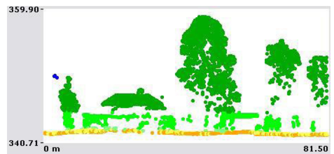
LIDAR 点群データの垂直断面表示
