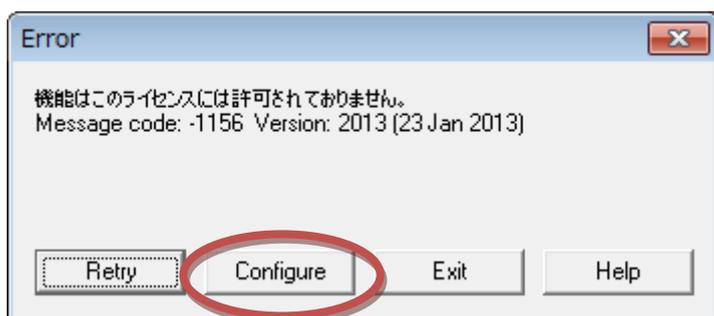
Configure をクリックして Basic に切り替えます。その後、TNTmips を再度起動してください。
