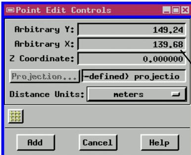
Point Edit Controls (点編集コントロール) ウィンドウには十字線ツールの座標が表示されます。
