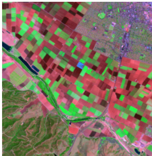
Red=TM7、Green=TM4、Blue=TM2のLandsat Thematic Mapperのカラー・コンポジット画像。このシーンでは、牧場の一方の側には市街地(右上)が、反対側には草に覆われた丘(左下)が見えます。
