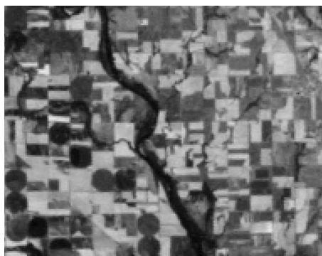
米国カンサス州の、この年の夏季の午前半ばの時間帯の熱赤外線画像では、温度の低い河川の表面、樹木のある両側の帯状部分、全面が作物で覆われた農地が暗く表示されています。明るい原野の部分は剥き出しの土壌です。Landsat 7 ETM+により、バンド6、地上解像度 60m で撮影。
