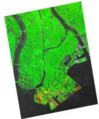
千葉県、PALSAR-1 PSI処理の例。平均変動率は、-2.5cm /年(赤)~+2.5cm /年(青)間のカラースケールを用いて表示。
