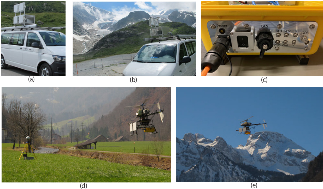
図1. (a)と(b): 送信用アンテナ1台と受信用アンテナ3台を備えたコンパクトなFM-CW方式のLバンドSARシステムを車両に設置した様子。2018年、スタイン氷河での実証試験に用いられた(受信用アンテナはうち1台のみ使用)。(c) 交互送信用チャンネル2個、同時受信用チャンネル4個を備えたLバンドレーダのコネクタ盤。(d)と(e): 2019年冬、スイス中央部・ヴォルフエンシーエッセンにおいて、Aeroscout社VTOL UAV Scout B1-100機搭載LバンドSARの離陸時の様子(d)と干渉リピートパスSARデータ取得中の様子(e)。
