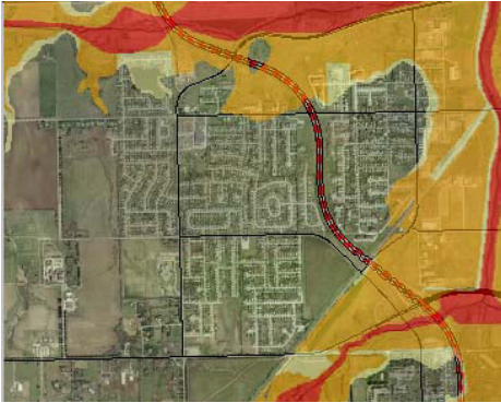
正射画像の上に表示された氾濫原(半透明表示)
