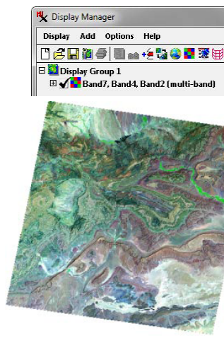
マルチバンドラスタレイヤとして追加 (Add as multiband raster layer) した例。選択したバンドのうち任意の3つを使用。カラー表示は変更可能。
