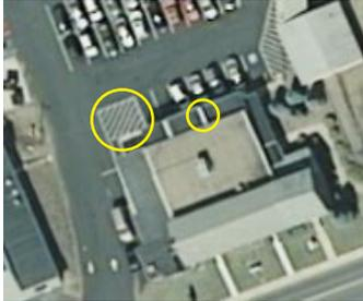
左図は解像度(セルサイズ)0.3mの正射画像の一部です。米国ペンシルベニア州のある地域の数個の小さなビルと隣接の駐車場が見えます。この画像についてNAD83/SPCS83ペンシルベニア南部ゾーンからWGS84/球面ウェブメルカトルへ再投影を行いました。セルサイズは0.2mにアップサンプリングされています。下の図は各種リサンプリング手法を適用した結果です。それぞれ、1倍(1ラスタセルが1スクリーンピクセル、左側)および左上隅の画像を2倍拡大したもの(右側)が示されています。リサンブル処理後の画像の違いは左のテスト画像の黄色の円の部分~駐車場の斜めの白線とビルの屋根の一部に明瞭に見てとれます。
