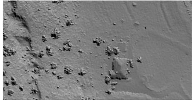
コロラド州デンバー郊外の狭い範囲 (さしわたし 165m) の正射画像 (左図) と LAS LIDAR ポイントから作成した起伏陰影の仮想地表面 (右図)。画像には、家屋、ドライブウェイ、まばらな樹木があります。この領域をカバーする LIDAR ポイント (下の左の図) の間隔は 50 ~ 70 センチです。裸地のポイントは自動処理を使って業者が分類したもので、残りのポイントは未分類のままです。仮想地表面は裸地と未分類ポイントをベースとしており、家屋や樹木が地形的特徴と共に仮想地表面上において明瞭に判別できます。仮想地表面の詳細については、テクニカルガイド「LIDAR: LAS 点群データの地表面表示」を参照して下さい。
