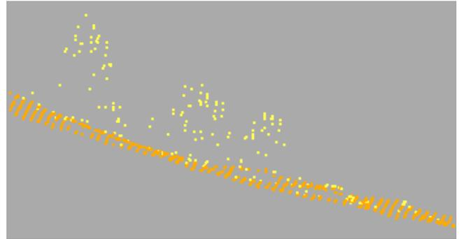
左の図は家屋のポイントを再分類した後の仮想地表面です。[ポイントプロファイル](緑の四角形)ツールを使って家屋敷地の北側の領域を調べています。枠内のLIDARポイントを使ってポイントの垂直断面図を作りました(右図。南から北を見えています。テクニカルガイド「LIDAR:ポイントプロファイルツール」を参照)。断面図中のポイントは、東に向かって下る坂を示す地面のポイント(オレンジ色)と樹木を示す未分類ポイント(黄)です。
