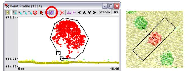
ポイントプロファイルの[ポリゴン]ツールを使って選択したLIDARポイント。選択ポイント(図中の赤色)は表示ウィンドウ(右)でも選択されます。断面図や平面図に球形に配置されたポイントの形や地表面上の高さから、これらのポイントのほとんどが樹木の枝葉からの反射であることが分かります。
