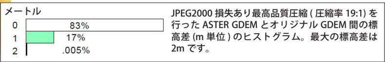
タイルをモザイクしたものは、エチオピアの様々な起伏の地形を含んでいます (上図)。この領域の GDEM タイルの非圧縮サイズは、223MB です。このモザイクを損失あり最高品質 JPEG2000 圧縮で GeoJP2 ファイルにエクスポートした場合、サイズは 12MB になります (圧縮率にすると約 19:1)。上のグラフで分かるように、損失あり圧縮をしたモザイクのセルのうち 83% がオリジナルの DEM と同じ値を保持しており、残りのほぼ全てのセルに関しても差は 1m でした。オリジナルの DEM との最大の差は 2 m でした。この差は前述の ASTER GDEM データの垂直方向の精度 (20m) より十分低く、オリジナルの DEM と比較しても圧縮した DEM の精細度が視覚的に落ちることはありません。
