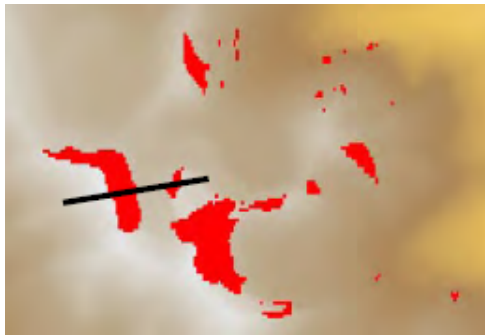
赤い部分はデータの穴と、参照用 DEM からの高度差が 75 メートル以上ある SRTM DEM セルを示しています。75 メートルは、DEM 値と置き換えるためにこの例で使われた高度差のしきい値です。
