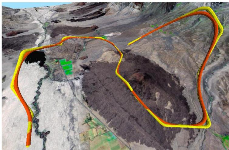
TNTsim3D で録画・平滑化した飛行経路を異なる方角から 3 次元表示しています。黄色の 3 次元ラインは加工前の飛行経路で、オレンジ色の 3 次元ラインは一度平滑化処理した後の経路を示しています。この図を作成するために、飛行経路はテキストファイルで保存され、3 次元のベクタラインとして TNTmips にインポートされ、3 次元グループに表示しました。
