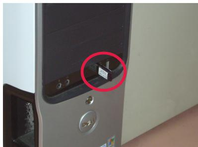
キードライバがインストールされているコンピュータに TNTmips Basic のライセンスキーを接続します。キードライバがインストールされていない場合は、「③キードライバのインストールとキーの接続」を参考に、キードライバをインストールしてください。
