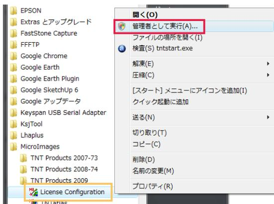
ユーザーアカウント制御が有効な場合は、[License Configuration] の上で右クリックメニューを呼び出し、[管理者として実行...] を選択します。
