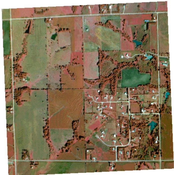
アフィン変換したCIR画像によって回転・拡大縮小した画像。ただし区分線の湾曲と傾き(さらに複雑な傾斜歪みや起伏変位による影響)は修正されていません。
