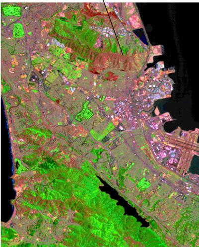
(UTM座標系に変換し、向きを変えた) 出力ラスタセット。強調のため境界に沿ってUTMのグリッドに印を付けて示してあります。
