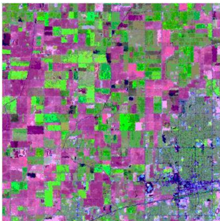
6月の照射条件に合わせて正規化された4月のランドサットTM画像。RGBのバンド割り当てはそれぞれ、TM5、TM4、およびTM3になっています。
